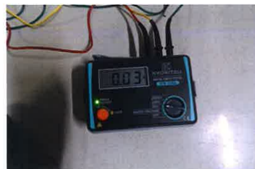
ค่าความต้านทานดินของหม้อแปลง 0.03 โอห์ม
